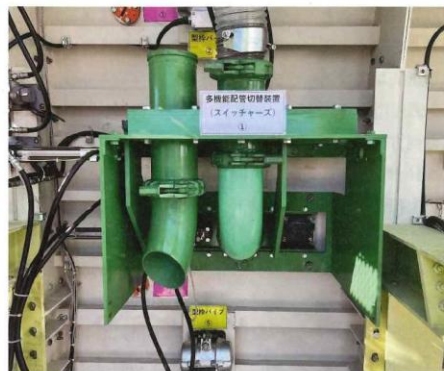
資料1 ■ トンネル用の型枠であるセントルの実大模型に取り付けたスイッチャーズ（写真：戸田建設）
